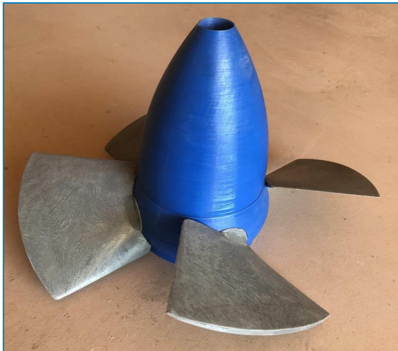
Ensemble des éléments dynamiques. 4 pales insérées sur le moyeu, le tout coiffé par l'ogive. impression 3D/PETG
